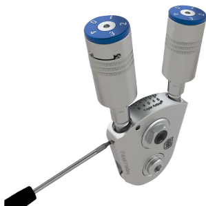
図1. ROM調整を行う時は、1.5mm六角棒レンチを使用して、ROMロックセットスクリュー（ROM緩み止めねじ）を解除し、調整後は固定します。
