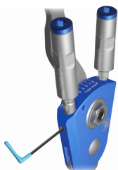
図1. ROM調整を行う時は、1.5mm 六角棒レンチを使用して、ROMロックセットスクリュー (ROM緩み止めねじ) を解除し、調整後は固定します。
